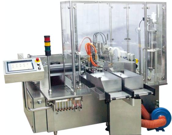
• **Envase** (estação de dosagem) por sistema dosagem com bombeamento da solução via pistão de êmbolo rotativo (Inox 316L, eletro polido e certificado).
